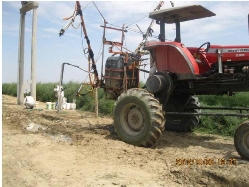
**Figura 22.** Tractor zancudo utilizado para aplicaciones de productos químicos.
