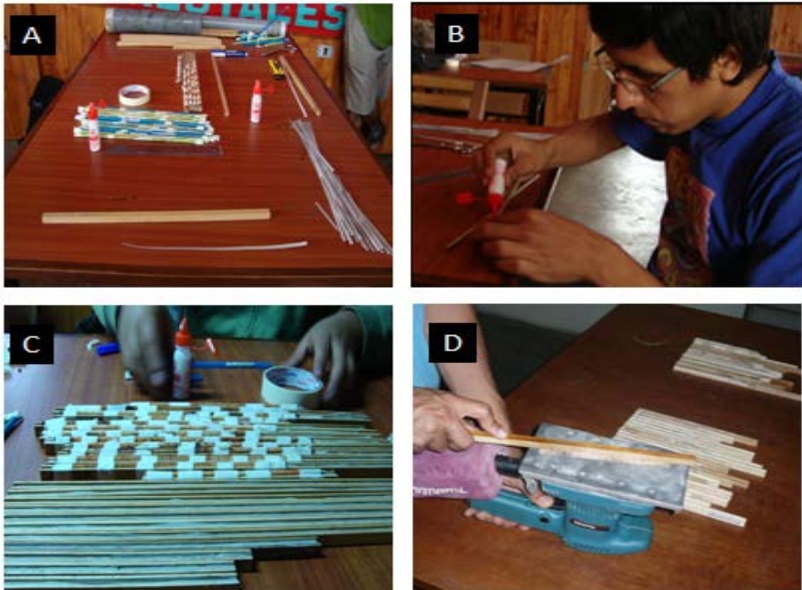
Figura 6 (A) Materiales para montaje de muestras; (B) montaje de muestras; (C) muestras acondicionadas; (D) pulido de sección transversal de muestras.
