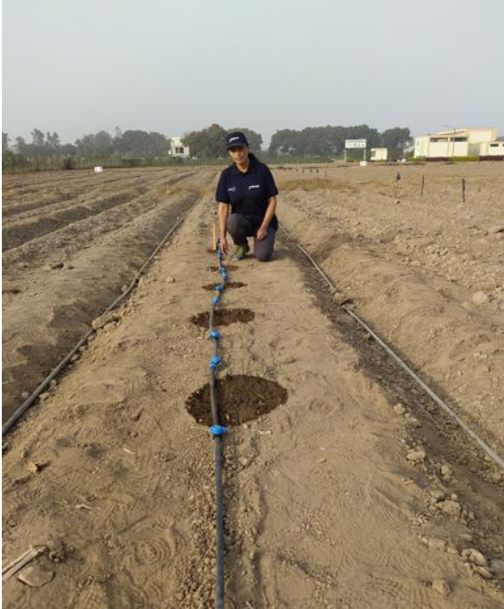
Prueba de bulbo húmedo , vista de planta.
