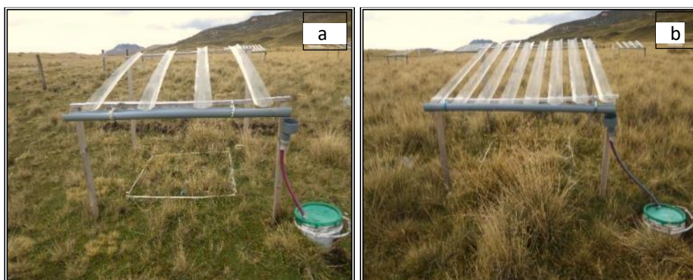
Figura 8: Modelo de interceptor de 30 por ciento (a) e interceptor de 60 por ciento de la precipitación (b)
