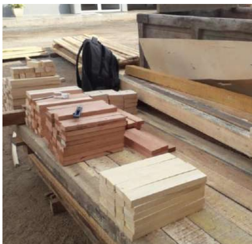
Figura 7: Listones obtenidos a partir de los residuos de madera
