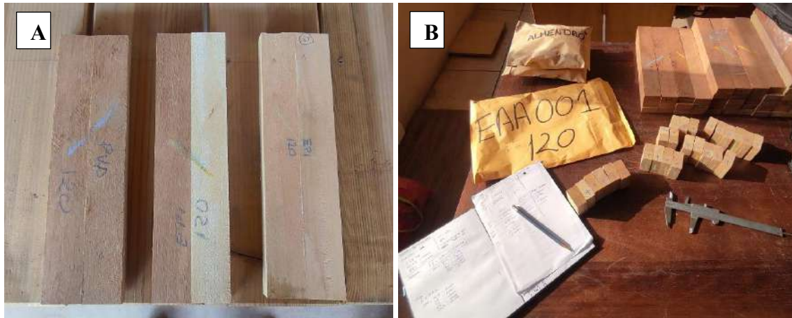
Figura 10: Listones con juntas laterales encoladas y probetas preparadas para el ensayo de cizallamiento
