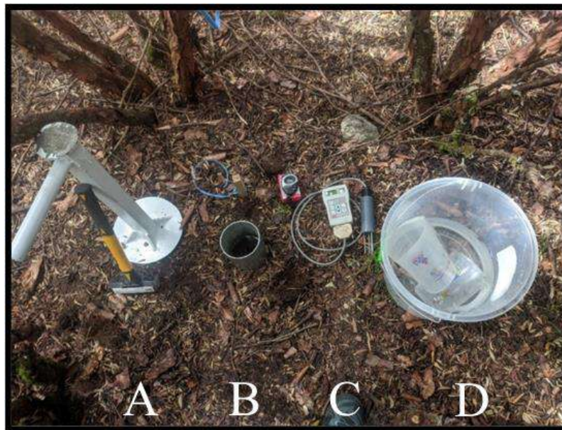
Figura 22: Materiales utilizados en el ensayo de infiltración: (A) herramienta de nivelación y comba, (B) infiltrómetro simple, (C) cronómetro, (D) balde con agua y jarra medidora.
