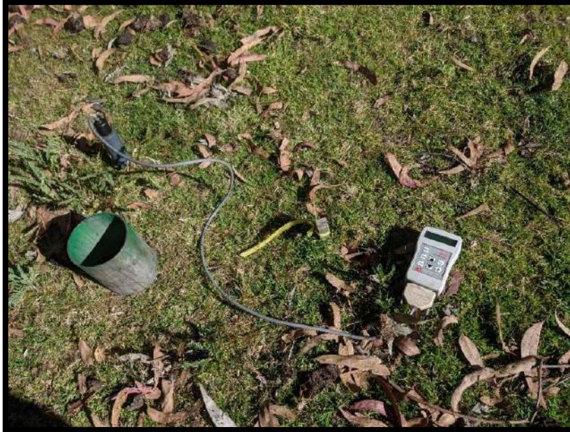
Figura 21: Medición de humedad del suelo alrededor del punto de ensayo de infiltración
