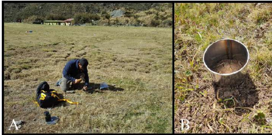
Figura 17: Instalación del cilindro (A) para extraer la muestra de suelo (B)
