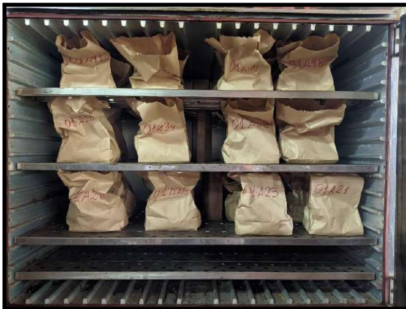
Figura 24: Secado de las muestras de suelo en la estufa
