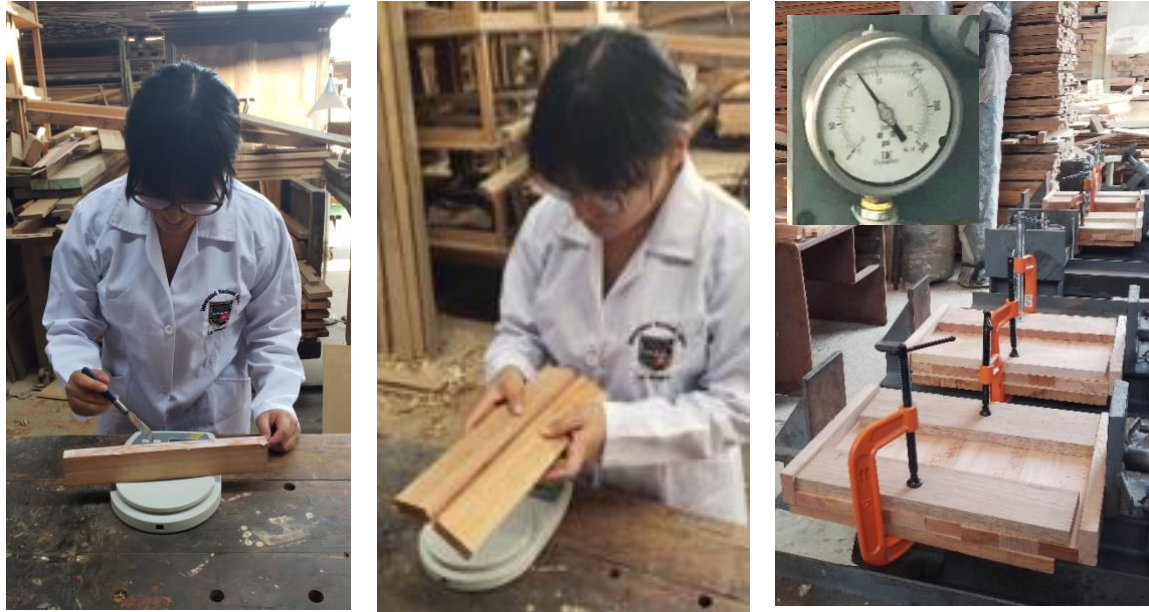
Figura 10: Proceso de encolado y prensado de juntas laterales
