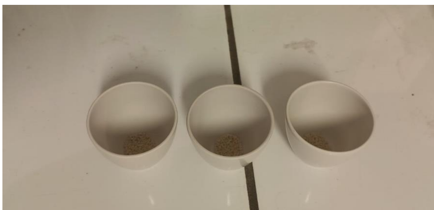
Figura 7: Contenido de cenizas obtenido de muestras de aserrín de Eucalyptus grandis Hill ex Maiden
