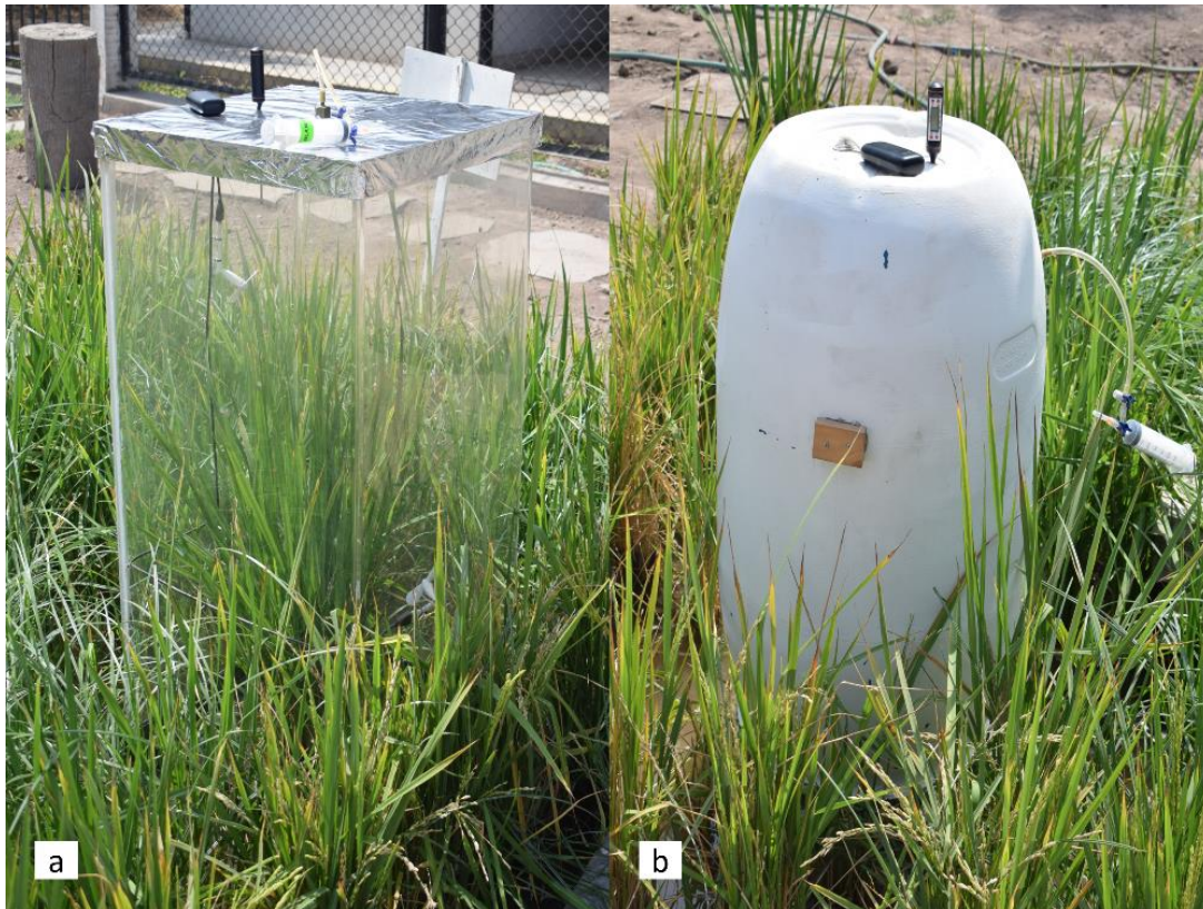
Figura 8. Cámaras estáticas cerradas en campo: transparente (a) y opaca (b).
