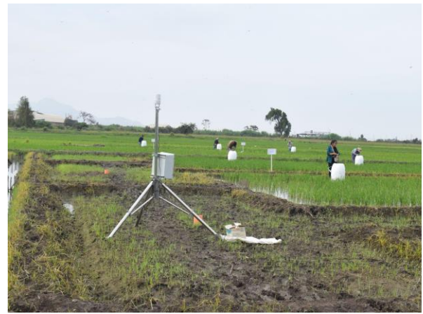
Estación meteorológica Atmos41 (06/03/23)
