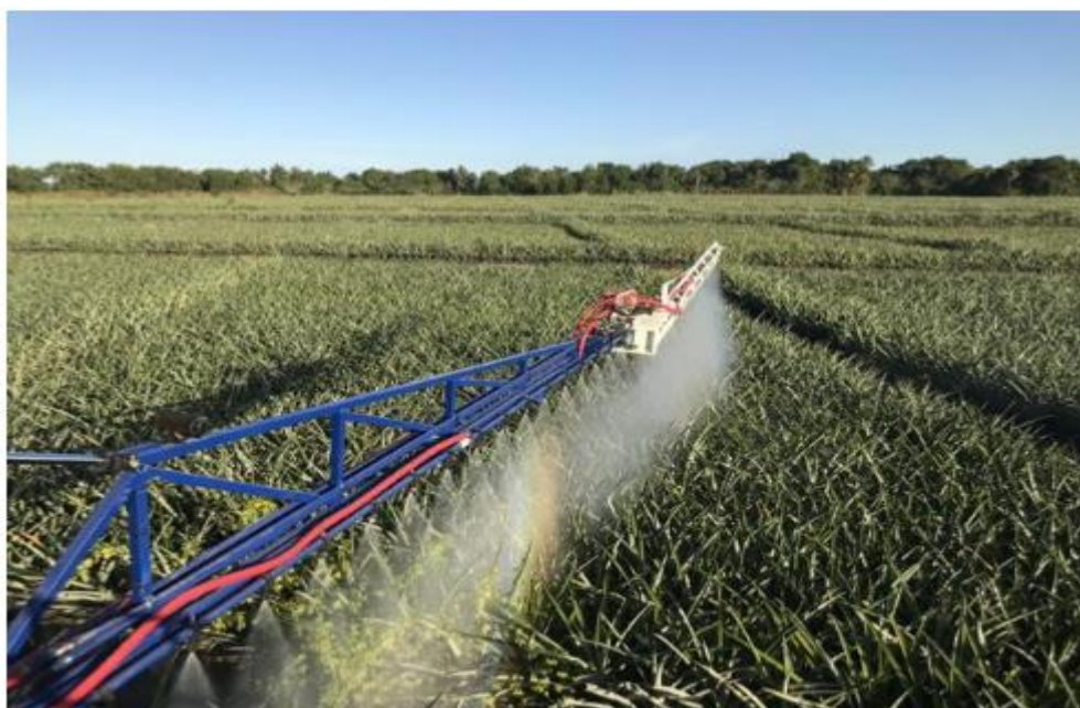
Figura 67. Aplicación foliar de la bomba de pulverizado de 6 mil litros
