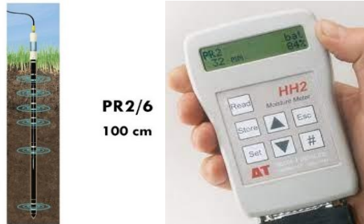
Figura 6. Equipo de medición de humedad de suelo - PR2.
