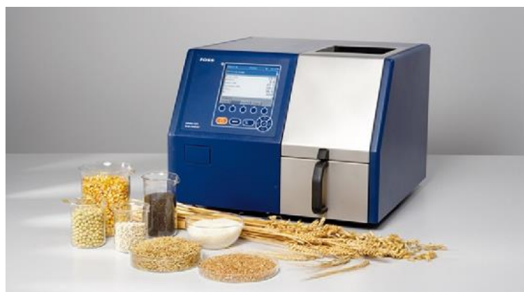
Figura 52. Sistemas Infratec 1241 para determinación de proteína, humedad, grasa, fibra, almidón, amilosa, color, aceite y peso específico en grano de cereales.
