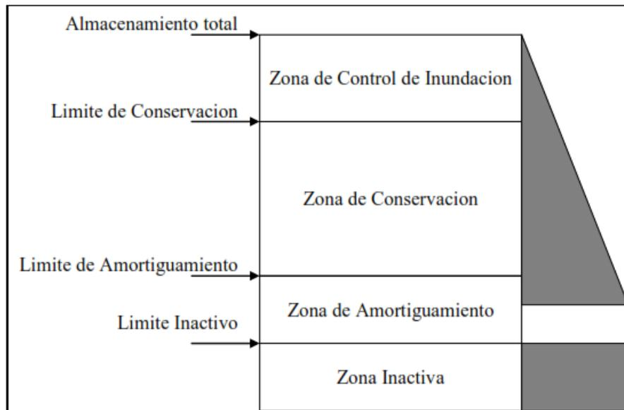
**Figura 4: Zonas de modelamiento de embalse en WEAP**
