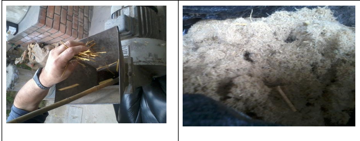
Figura 14: Imagen de molienda de muestra de junco: (izq) ingreso de muestra a molino disco; (der) muestra molida
