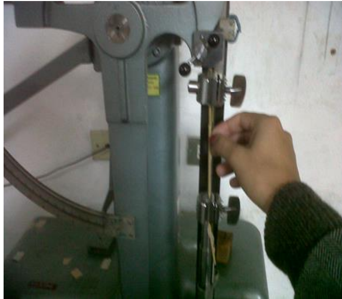
Figura 11: Forma de colocación de probeta para ensayo de tracción y alargamiento
