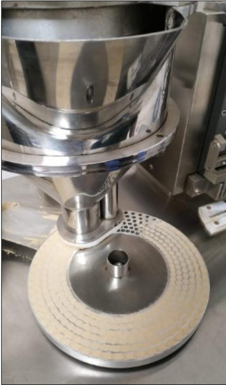
Retiro del molde con cápsulas para la expulsión de cápsulas
