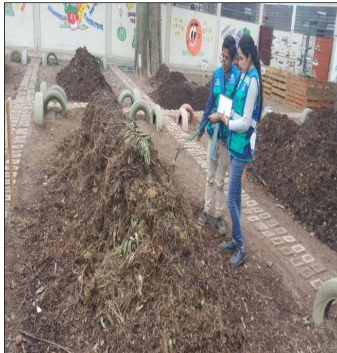
Figura p. Monitoreo de temperatura y humedad de la pila de compost
