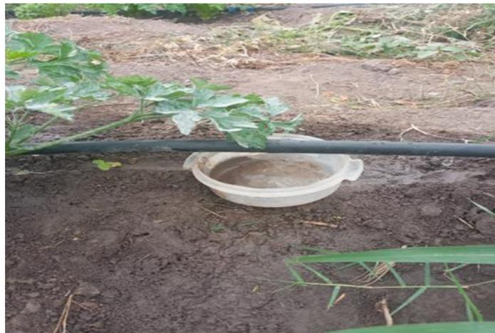
**Figura 17: Muestreo de volumen medición de caudal del gotero**
