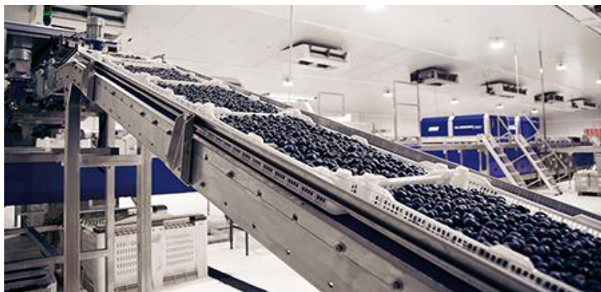
Figura 24: Calibradora de arándanos, clasificadora y seleccionadora
