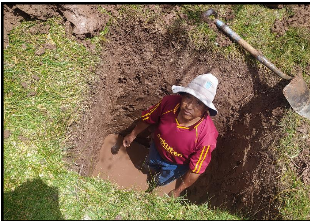
Figura 29: Realización de la calicata para determinar el nivel freático y extraer la muestra de suelo.
