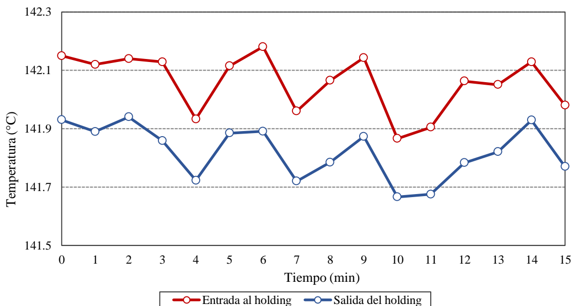
Figura 23: Monitoreo de la temperatura del producto al ingreso y a la salida del tubo de retención durante la ejecución del ensayo N° 1 de la prueba de esterilidad
