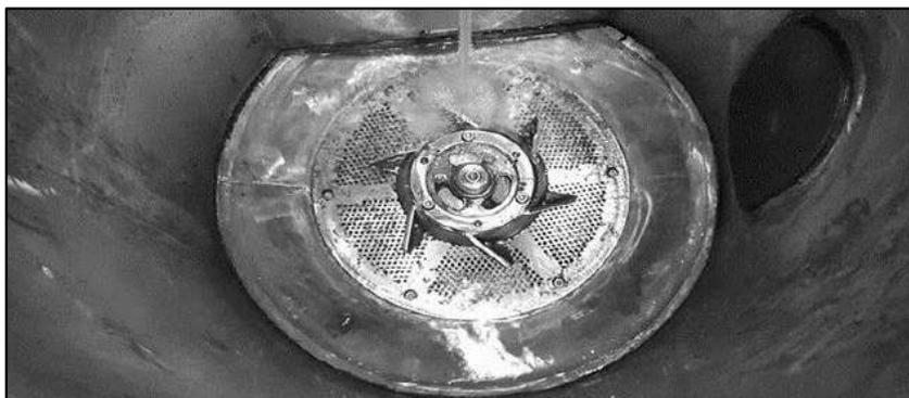
**Figura 24: Rotor y placa perforada en el fondo del pulper tipo delta.**
