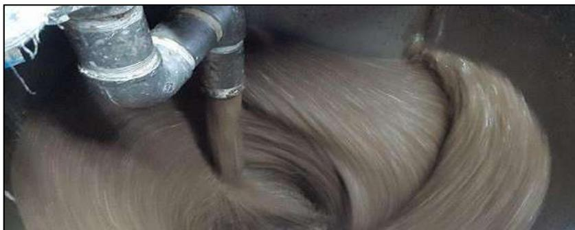
**Figura 23: Pulper delta desintegrando la mezcla DKL y OCC.**
