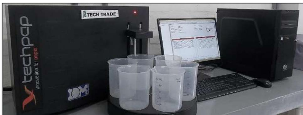
**Figura 28: Equipo Morfi Compact para análisis de las pulpas antes y después del refinado.**
