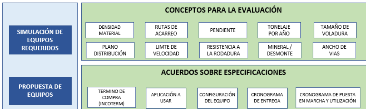
Figura 7: Proceso requerido: simulación de carga y acarreo de materias y propuesta de equipos
