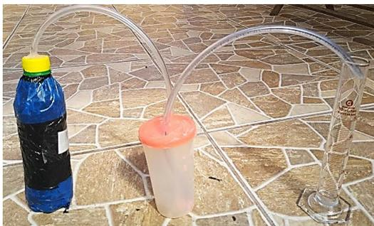
**Figura 8: Biodigestor a pequeña escala (BPA) construido para el estudio**
