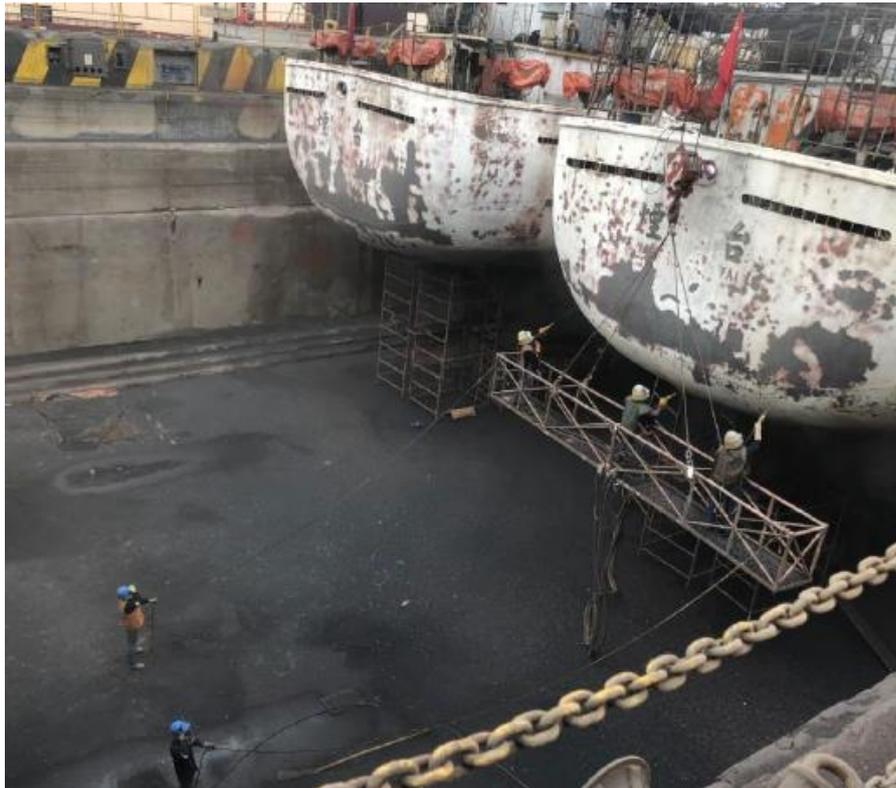
**Figura 5: Proceso de arenado en un astillero del Callao, Perú**
