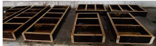
Moldes para adoquines para pavimento tipo I fabricados con material fenólico y dimensiones: 20cm de largo / 10cm de ancho / 6 cm de altura
