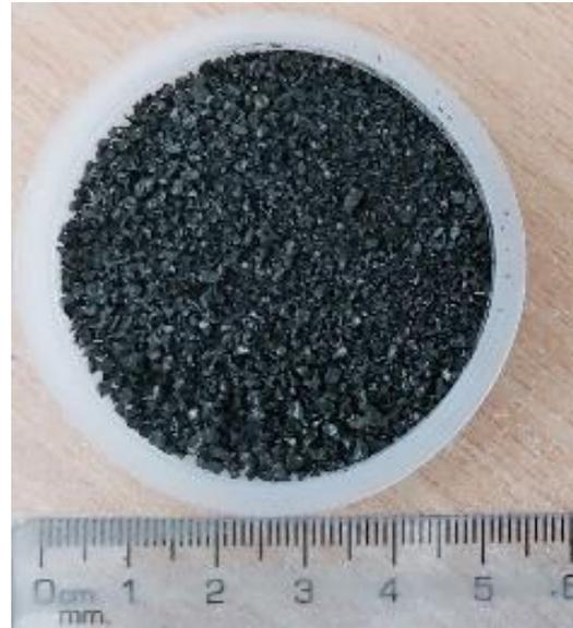
**Figura 4: Residuos de escoria de cobre**
