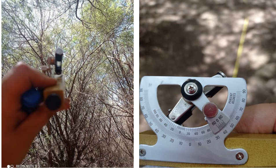
Figura 14. Uso del clinómetro Hope 5 ¼ para la toma de datos de altura total de los árboles inventariados en las parcelas establecidas en el área de estudio.
