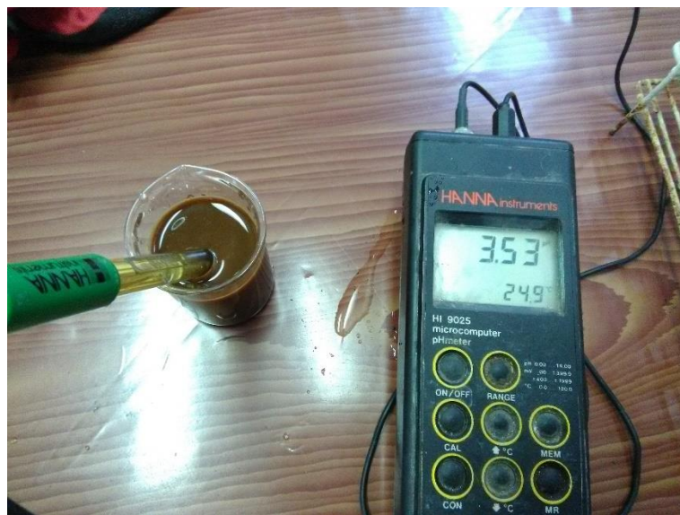
Fotografía 2: Laboratorio de biorremediación, determinación de pH de biol II-G
