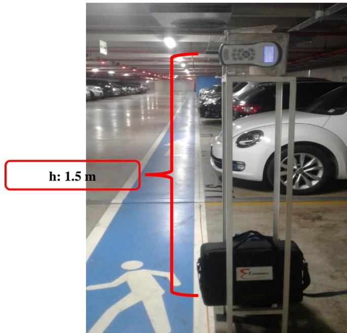
**Figura 10:** Caseta, analizador de gases, y altura de monitoreo
