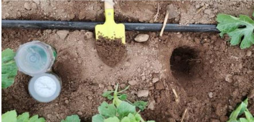
**Figura 5:** Instalación de tensiómetros entre plantas
