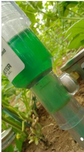
**Figura 6:** Tensiómetro con burbujas
