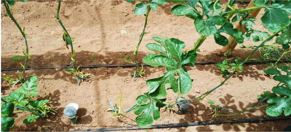
**Figura 22:** Tensiómetros de 15 cm y 30 cm
