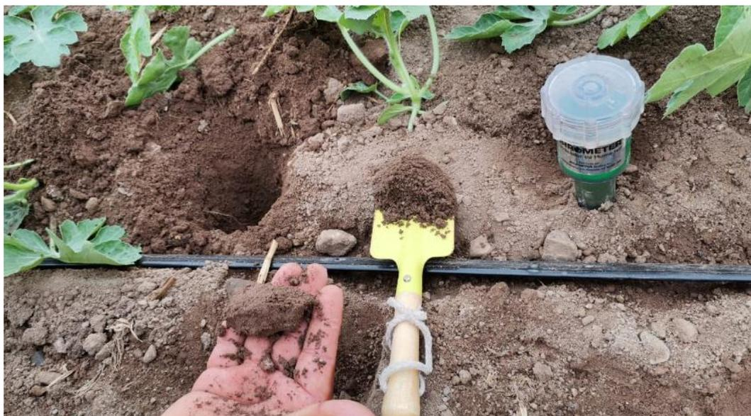
**Figura 25:** Determinación de humedad de una muestra de suelo tomada a 15 cm
