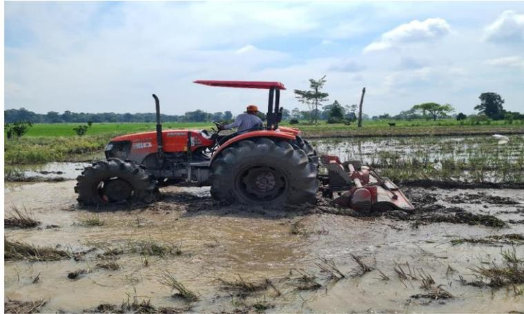
**Figura 10. Tractor con rotativa o rota.**
