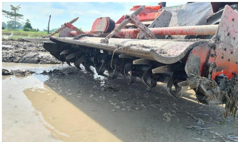
**Figura 11. Aplicación del tractor con rotativa o rota.**
