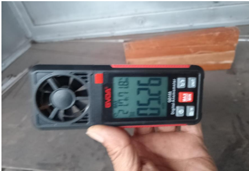
a3.2: Medición de la velocidad de arrastre( V_a ), en el extremo izquierdo de la cámara de soldado.
