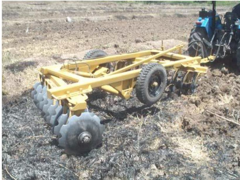
**Figura 3. Pase de grada en suelo seco**
