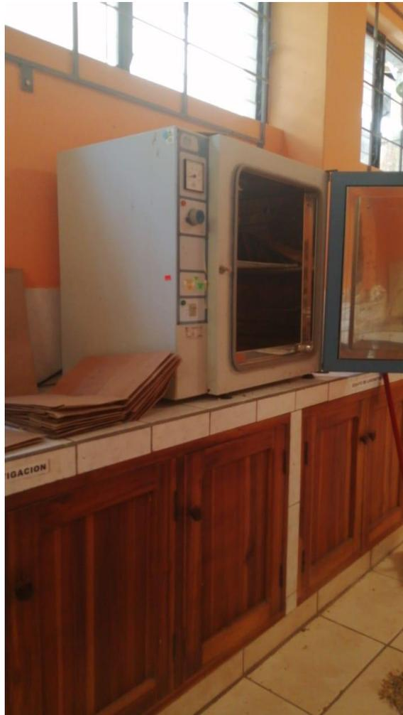
**Figura 13: Horno de secado por convección**
