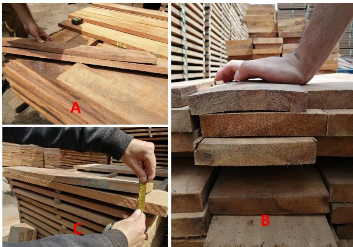
Figura 17: A. Acanaladura B. Abarquillado C. Torcedura
