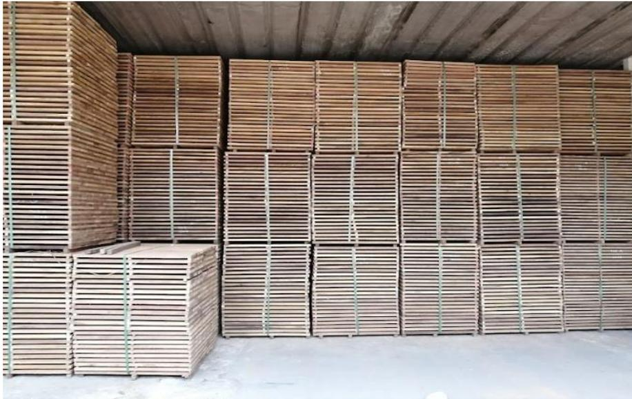
Figura 9: Ordenamiento de módulos en la cámara de secado
