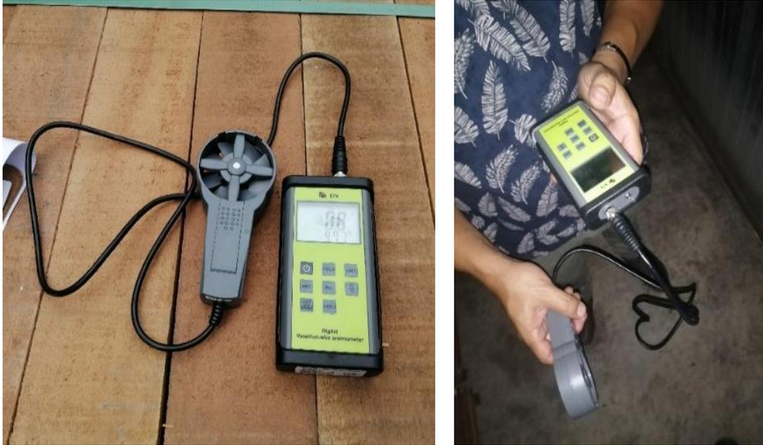
Figura 10: Evaluación de la velocidad del aire con el anemómetro
