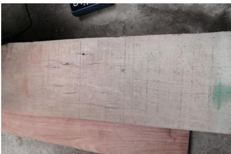
Figura 15: Presencia de grietas en la cara y cantos
