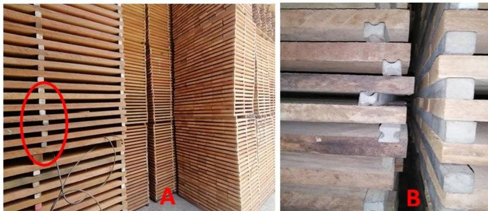
Figura 8: Verticalidad de separadores y protección de extremos
