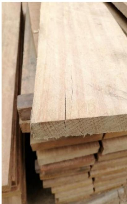
Figura 16: Presencia de grietas en la cara y los extremos
