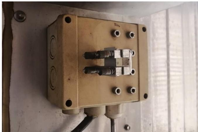
Figura 3: Placa Higroscópica
