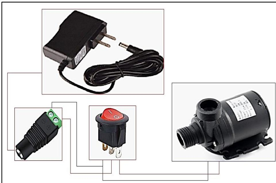
Figura 28: Conexión eléctrica de bomba-interruptor
