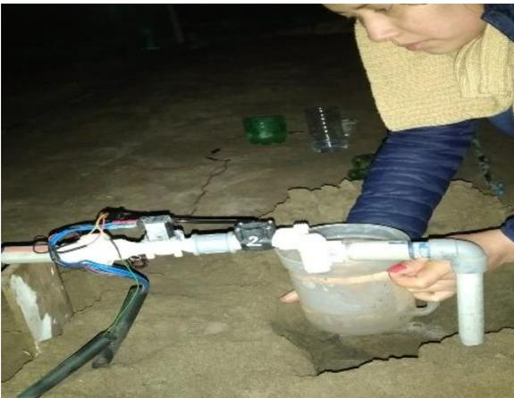
Calibración en campo del sensor de flujo
