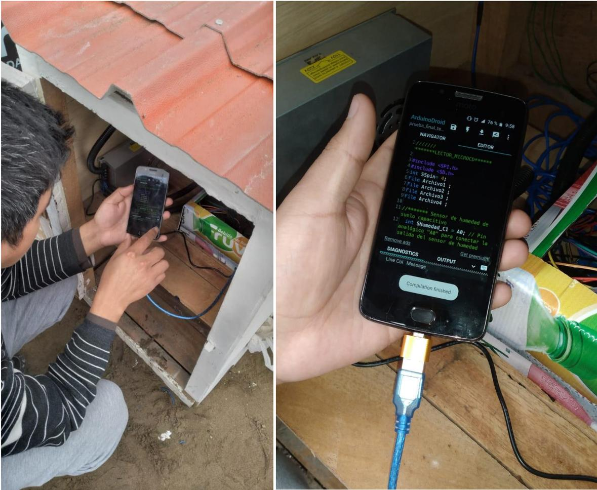
Figura 36: Encendido utilizando el aplicativo Android del celular
