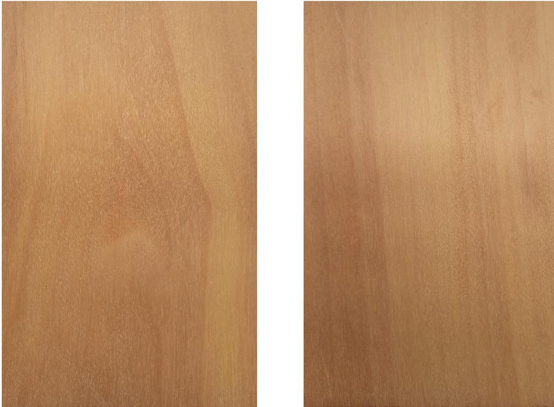
**Figura 2:** Madera en corte tangencial y radial de *Aspidosperma cylindrocarpon*
