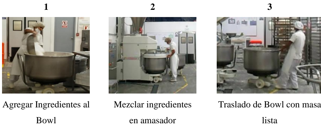
Figura 18: Secuencia de proceso de Amasado
