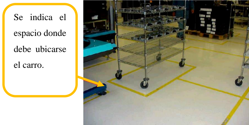
Figura 7: Ejemplo de Poka Yoke
