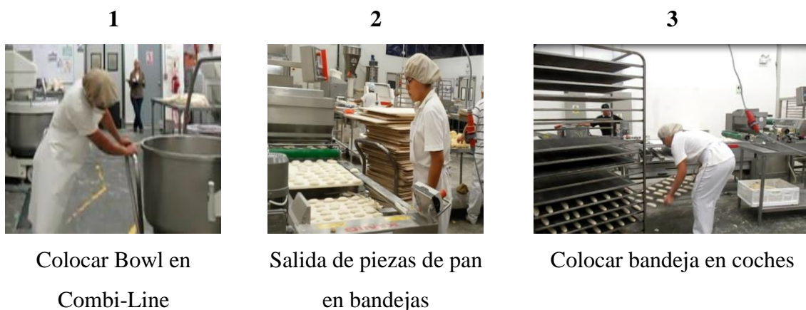
Figura 19: Secuencia de proceso de Formado
