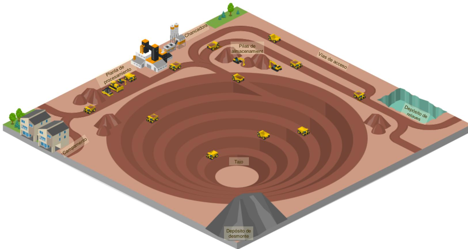
**Figura 2.** Principales componentes de una mina a tajo abierto
