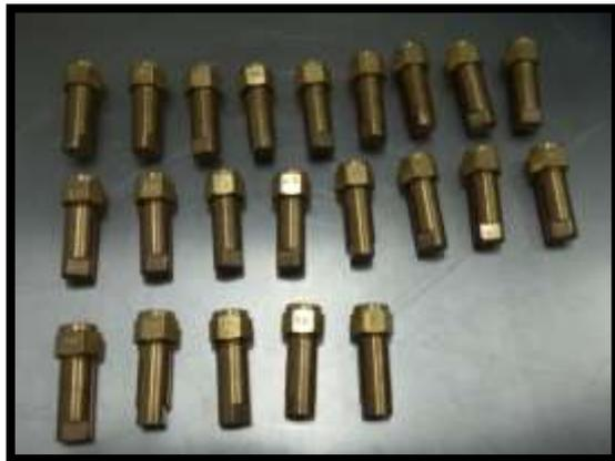
**Figura 2. Cápsulas de permeación**
