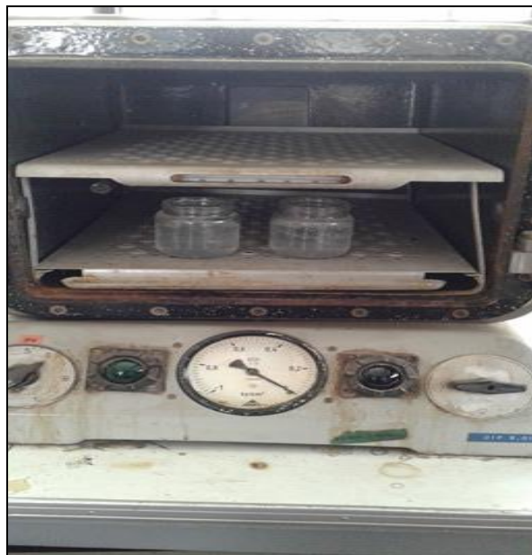
Figura 10: Cámara de vacío adaptado para simulación de envejecimiento acelerado
