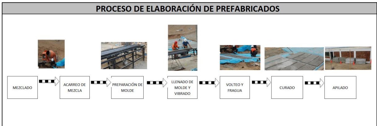
Figura 23: Proceso de elaboración de prefabricados
