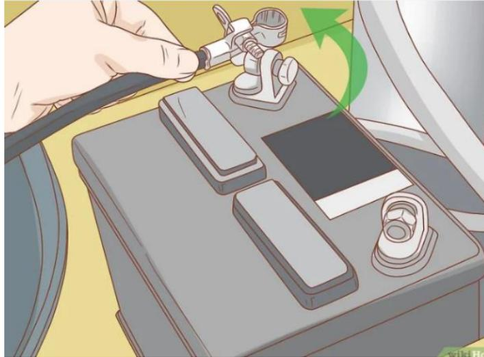
**Figura 21: Desmontaje de la batería**
