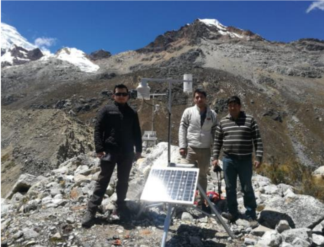
Figura 25: Microestación meteorológica (Arduino) instalada.
