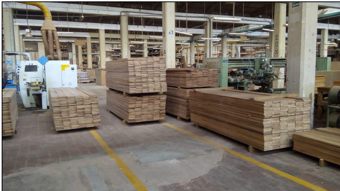
Figura N° 16. Paquetes cepillados cuatro caras usando una moldurera Weinig Unimat 500
