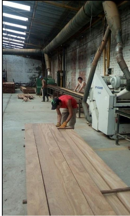
Figura N° 15: Cepillado cuatro caras utilizando una sierra circular múltiple y una cepilladora dos caras
