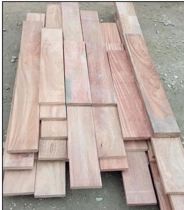
Figura N° 26: Piezas de decking rechazadas.
