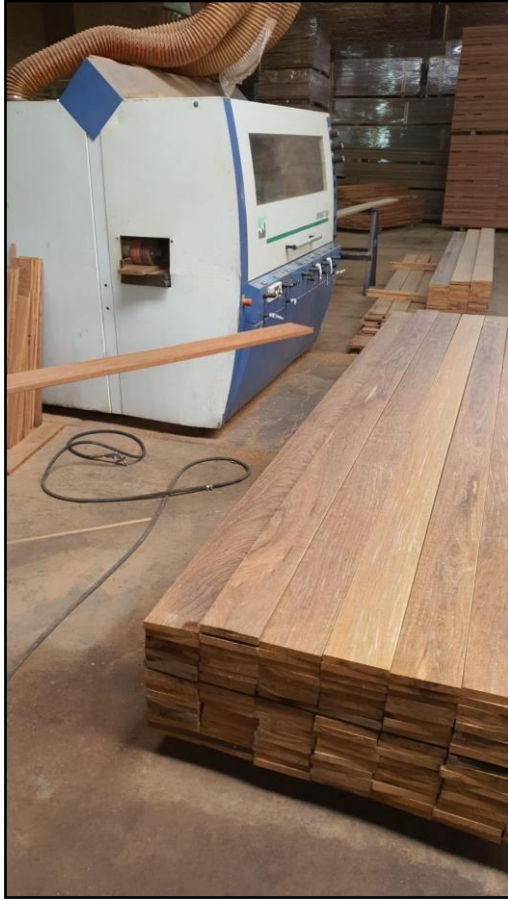
Figura N° 18: Proceso de moldurado
