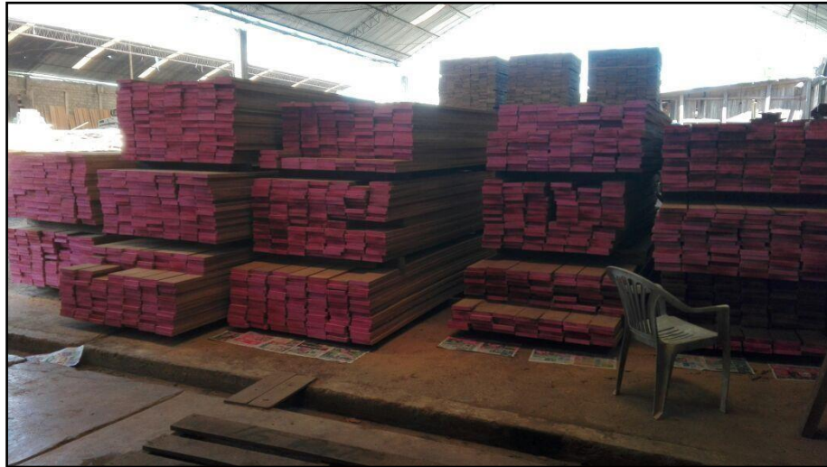
Figura N° 6: Pintado de secciones transversales
