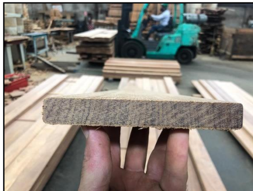
Figura N° 12: Decking 21 mm x 145 mm.
