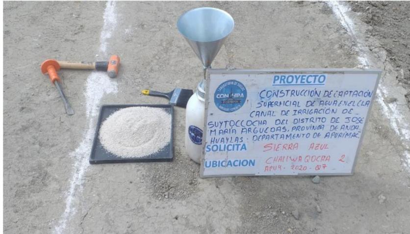
*Imagen 07. Ensayo de Densidad in situ y ensayo de determinación de la humedad con Speedy Apu4 -2020-Q7 Challwaqocha 2, punto 02.*
