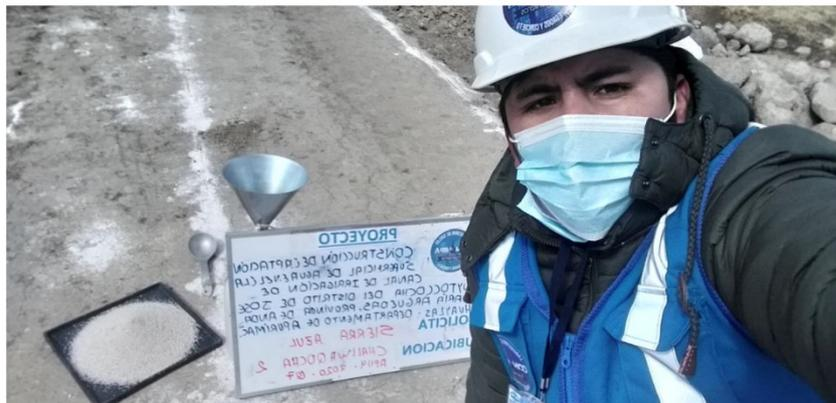
*Imagen 08. Ensayo de Densidad in situ y ensayo de determinación de la humedad con Speedy Apu4 -2020-Q7 Challwaqocha 2, punto 03.*
