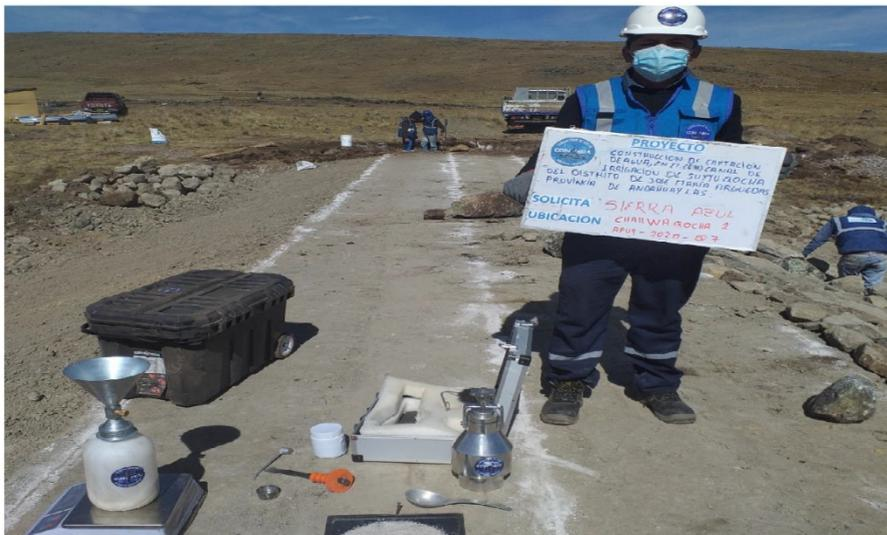
*Imagen 03. Ensayo de Densidad in situ y ensayo de determinación de humedad con Speedy Apu4 - 2020-Q7 Challwaqocha 2, punto 02.*
