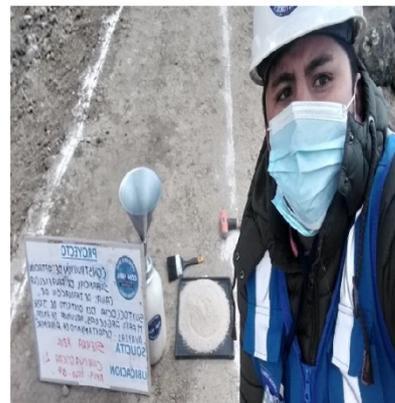
**Imagen 06.** Ensayo de determinación de la humedad con Speedy Apu4 -2020-Q7 Challwaqocha 2, punto 01.
