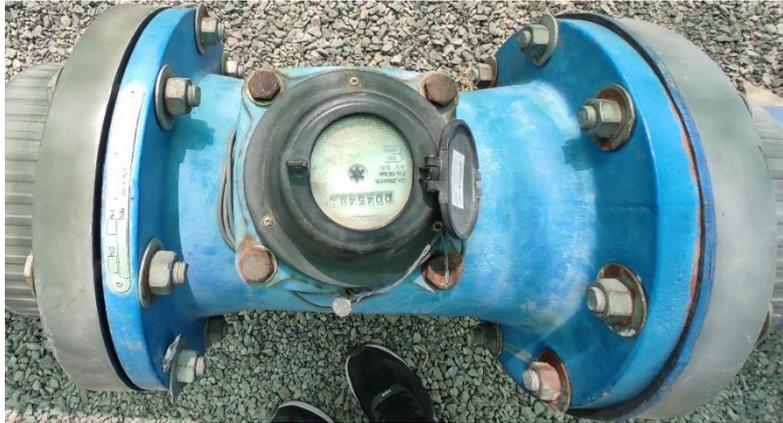
Figura 5: Flujómetro tipo woltman de 8" del pozo IRHS-11-01-04-255
