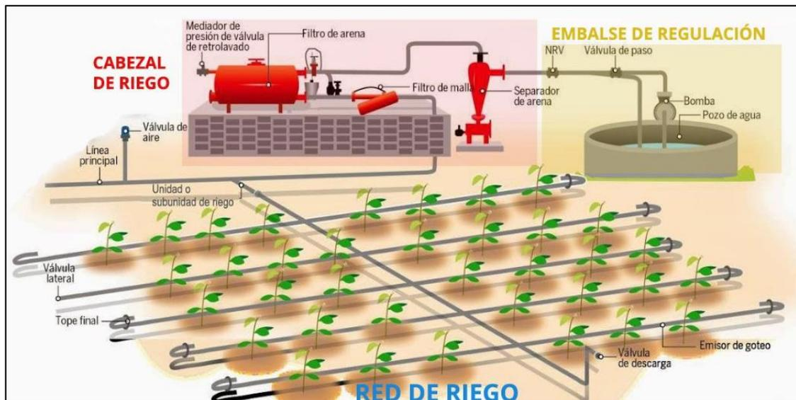
**Figura 6: Componentes de riego por goteo**
