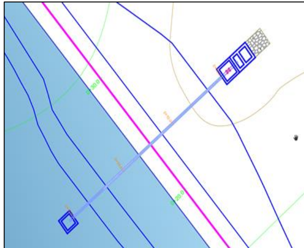
Figura 9: Estructura de Toma y Descarga
