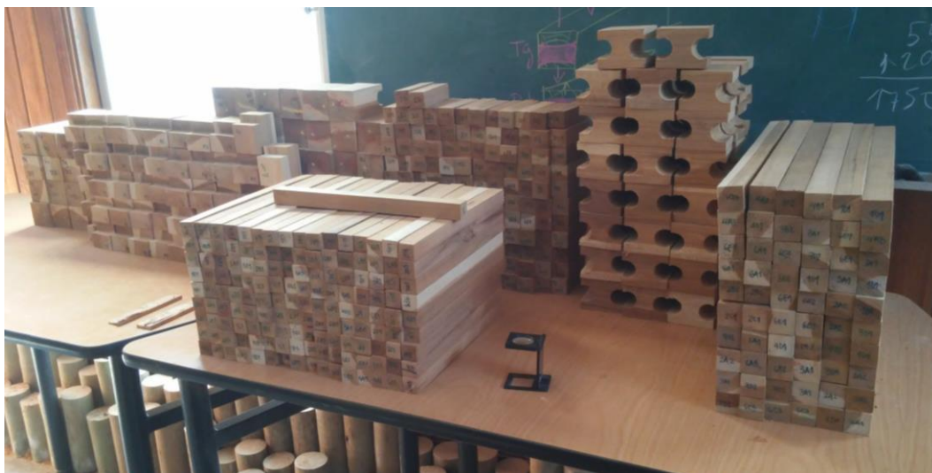
Figura 4. Probetas dimensionadas y codificadas
