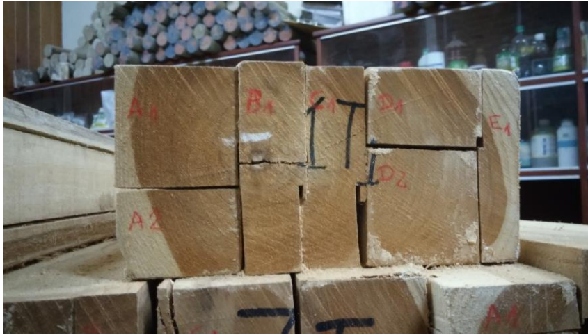
Figura 3. Distribución de cortes en cuarterones para obtención de probetas
