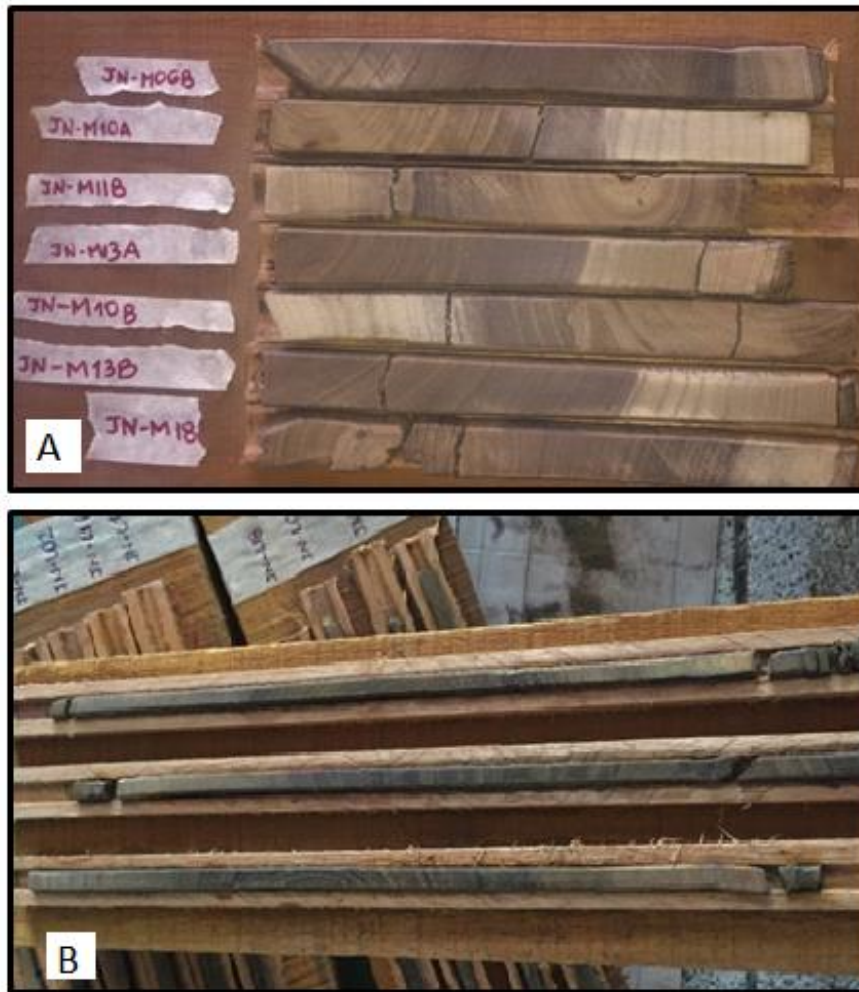
A. Muestra obtenida con la perforadora. B. Muestra obtenida con el Barreno.
