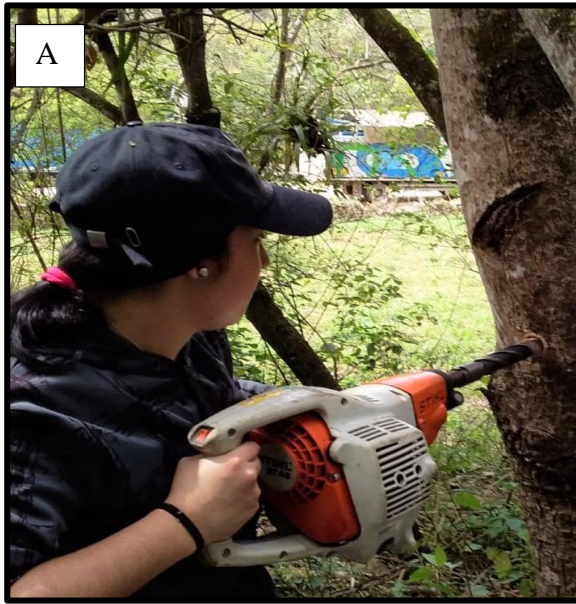
A. Extracción de muestras con perforadora Stihl BT45. B. Obtención de muestras con barreno de Pressler.
