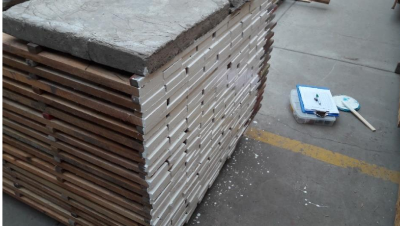
Figura 4: Pintado de testas de una carga de madera de 1” previo al ingreso al horno experimental.
