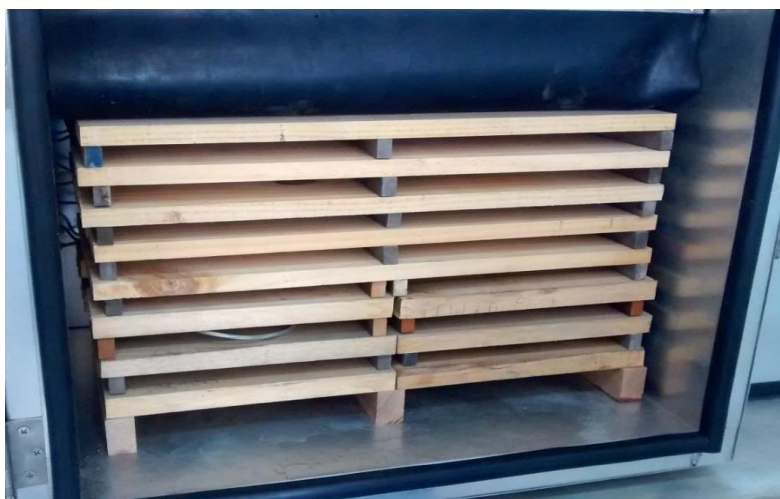
Figura 11: Carga de madera de 1" apilada para prueba en horno de 20 pt.
