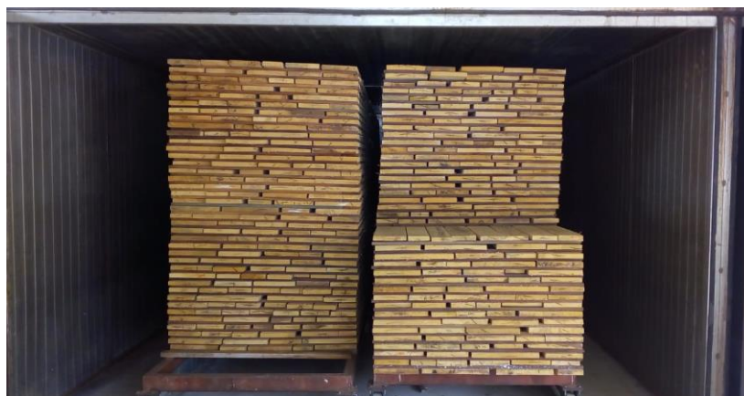
Figura 13: Carga de madera de Marupa de 1” en horno de 5 000 pt.
