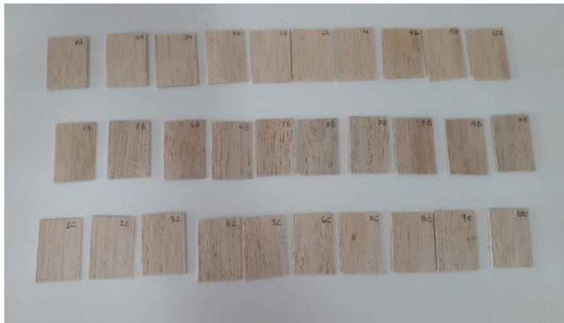
Figura 3: Láminas de madera de Bolaina blanca para ensayo de PSF.
