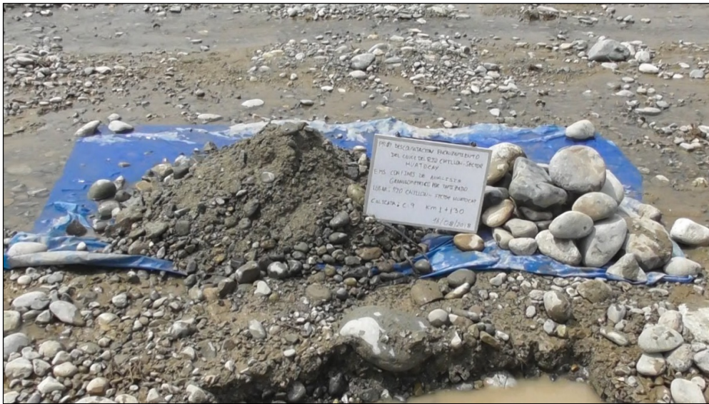
Foto 9 calicata 9 (C-9) para extraer muestras del material depositado por el río en su cauce.
