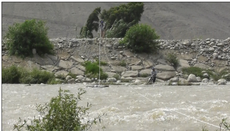
Foto 7 ADCP en movimiento obteniendo datos en la margen derecha de la sección de control Nro. 1 en el río Chillón.
