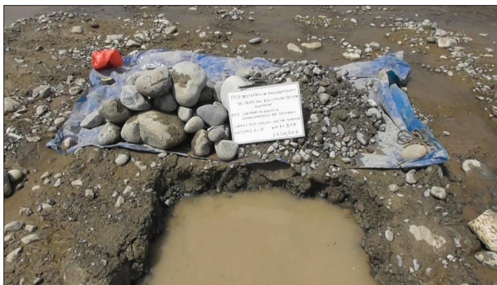
Foto 16 calicata 16 (C-16) para extraer muestras del material depositado por el río en su cauce.
