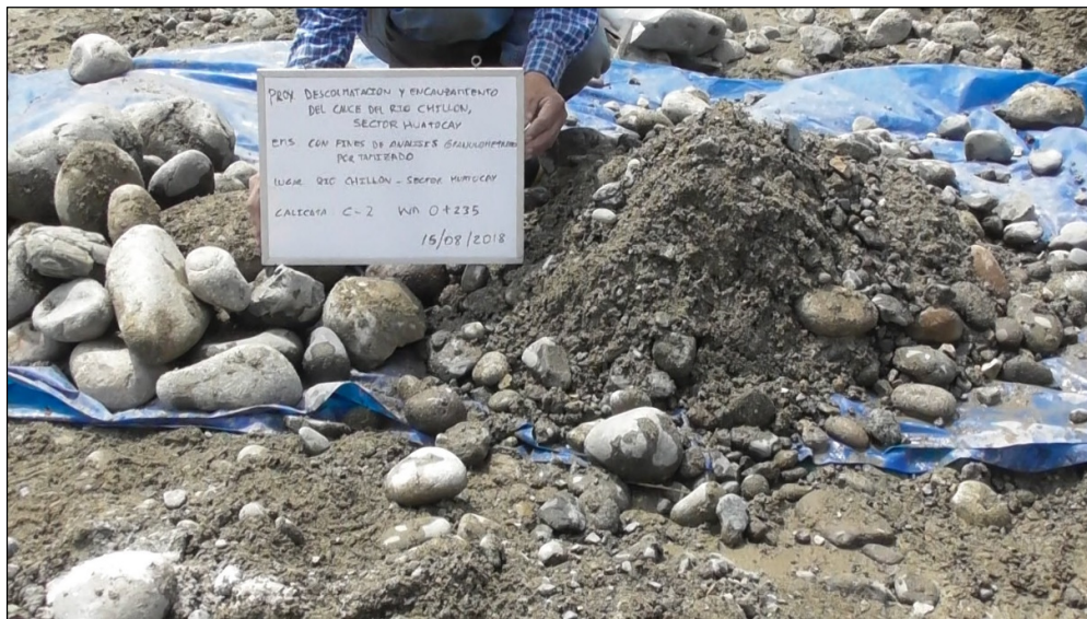
Foto 2 calicata 2 (C-2) para extraer muestras del material depositado por el río en su cauce.
