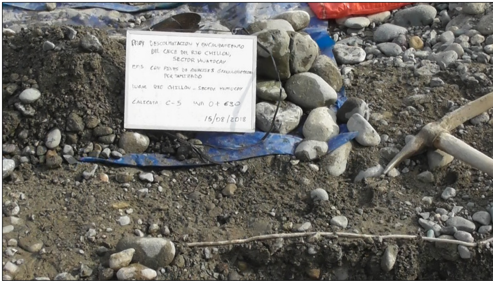
Foto 5 calicata 5 (C-5) para extraer muestras del material depositado por el río en su cauce.
