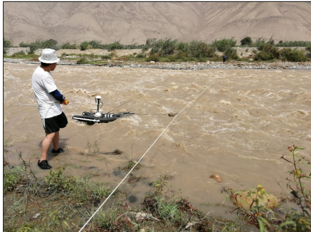
Foto 9 ADCP en movimiento obteniendo datos en la margen izquierda de la sección de control Nro. 2 en el río Chillón.
