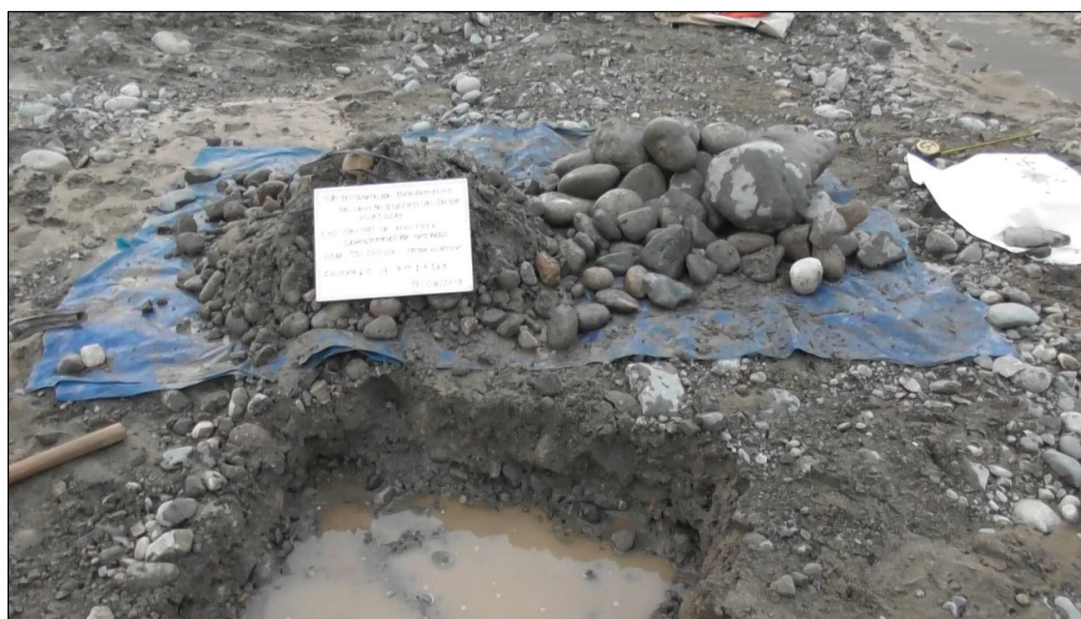
Foto 13 calicata 13 (C-13) para extraer muestras del material depositado por el río en su cauce.
