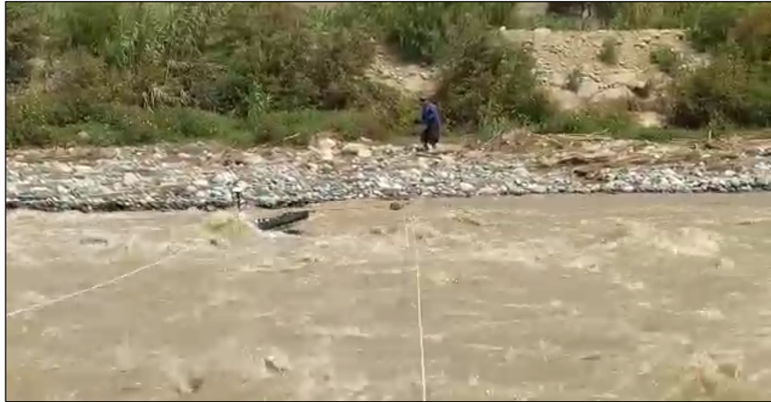
Foto 11 ADCP en movimiento, obteniendo datos en la margen derecha de la sección de control Nro. 2 en el río Chillón.
