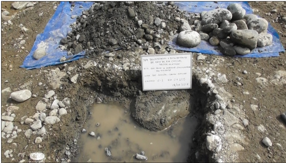
Foto 1 calicata 1 (C-1) para extraer muestras del material depositado por el río en su cauce.
