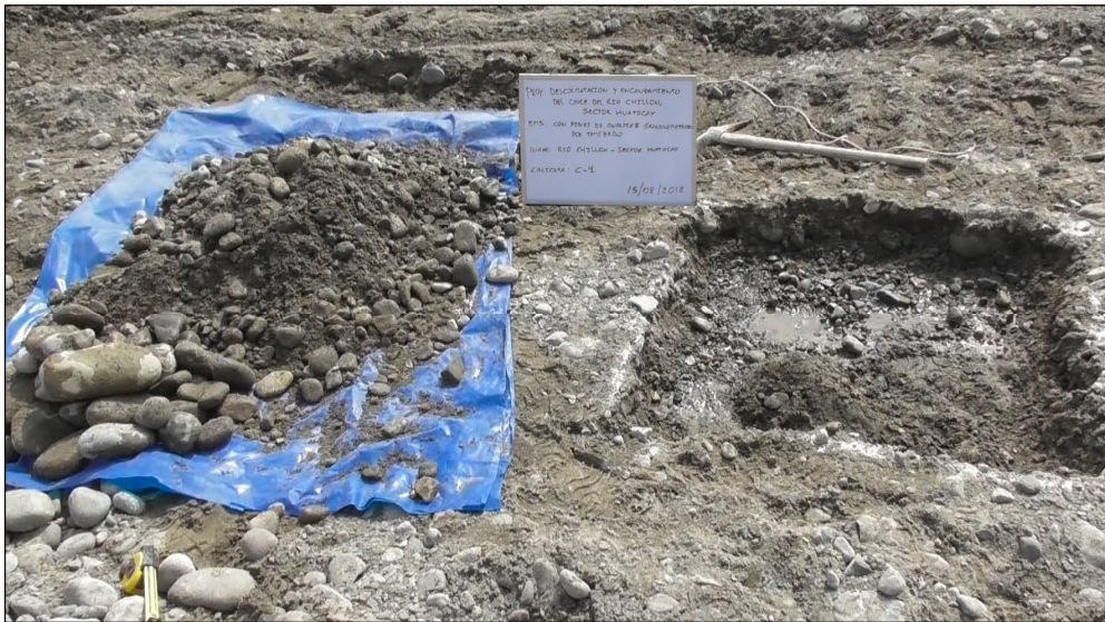
Foto 4 calicata 4 (C-4) para extraer muestras del material depositado por el río en su cauce.
