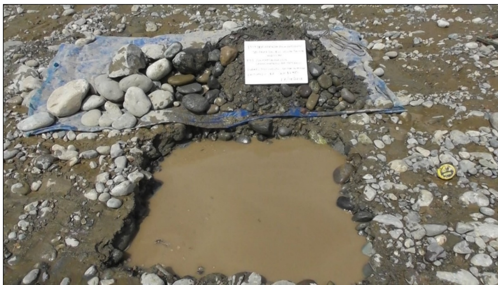
Foto 17 calicata 17 (C-17) para extraer muestras del material depositado por el río en su cauce.
