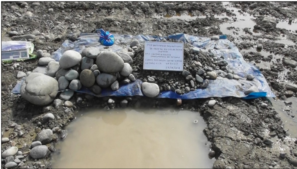
Foto 14 calicata 14 (C-14) para extraer muestras del material depositado por el río en su cauce.
