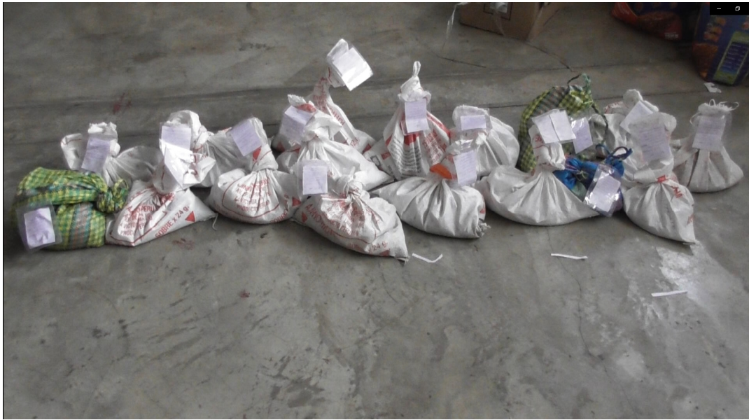
Foto 7 Separación de muestras de aproximadamente 5 kg de grava más material fino de la calicata, para posteriormente realizar el análisis granulométrico integral
