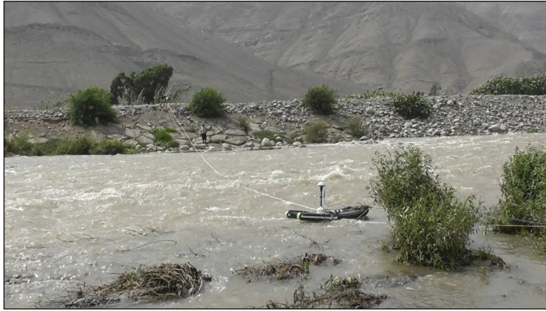
Foto 5 ADCP en movimiento obteniendo datos en la margen izquierda de la sección de control Nro. 1 en el río Chillón.
