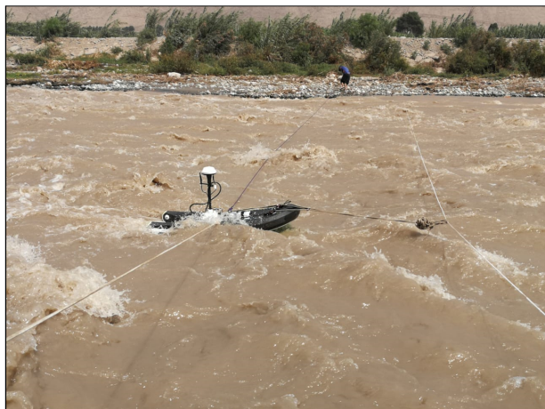
Foto 10 ADCP en movimiento obteniendo datos en el centro de la sección de control Nro. 2 en el río Chillón.
