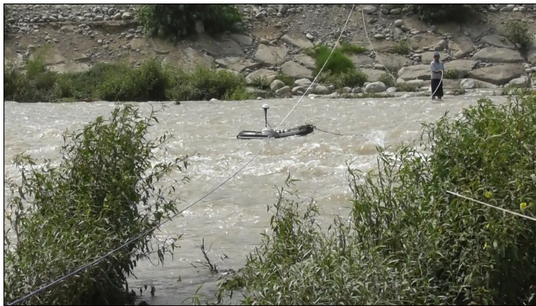
Foto 6 ADCP en movimiento obteniendo datos en el centro de la sección de control Nro. 1 en el río Chillón.
