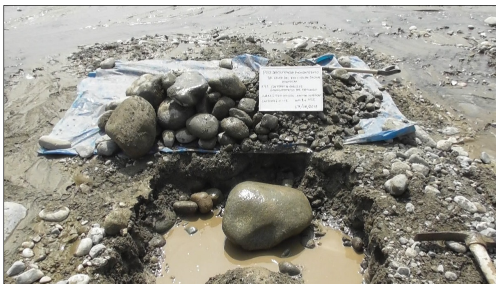
Foto 15 calicata 15 (C-15) para extraer muestras del material depositado por el río en su cauce.
