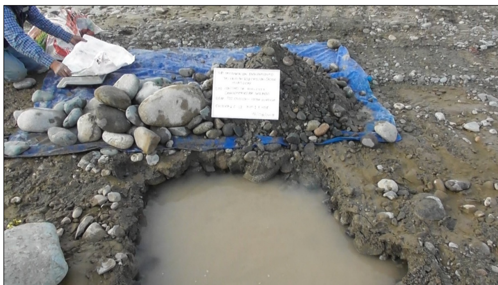
Foto 12 calicata 12 (C-12) para extraer muestras del material depositado por el río en su cauce.
