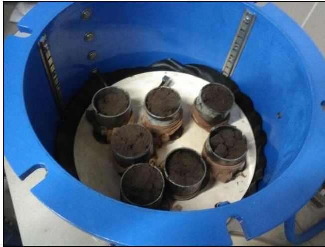
Figura 10: Muestras de suelo en la olla de Richard para determinar CC y PMP
